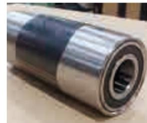
▲ベアリング直バメローラ(クラウン付) φ48.6×5.5t(肉厚パイプ)にベアリング#6204を圧入
