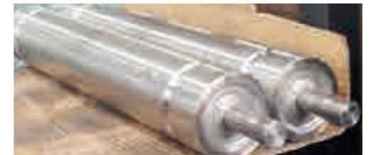
▲両側V溝(M型)プーリ(両端2か所) SUS製φ139.8×W600(肉厚パイプ)プーリに直接溝加工
