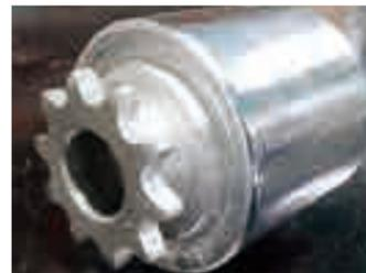
▲チェン駆動ローラ(Hcrメッキ10μ) φ60.5(肉厚パイプ)×W100 #40-10S表面焼入れ後、硬質クロムメッキ処理バフ仕上
