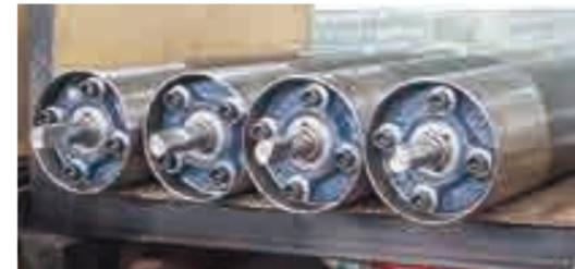
▲テールローラ(ベアリングユニット) φ114×W600軸径φ20 市販品のベアリングユニット(UCFC204)で構成
