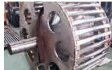
▲SUS製カゴ型プーリ φ500×W400(丸棒φ2530本)切削によるクラウン加工付 カゴの内部にはテーパ管を溶接し塵などを外側へ排出する構造のプーリです
